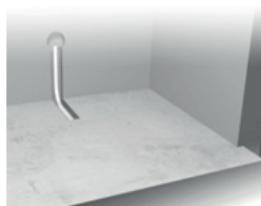
Vor dem Verlegen der Heizmatte auf dem Estrich, muss der Untergrund sauber, trocken, fest, staub- und schmutzfrei sein. Sollte der Unterbau uneben sein, so ist dieser vor der Verlegung der Heizelemente zu nivellieren, sodass Hohlräume unterhalb der Heizleitung vermieden werden. Bewegungsfugen in der Unterkonstruktion dürfen auf keinen Fall mit dem Flächenheizelement überbrückt werden.
