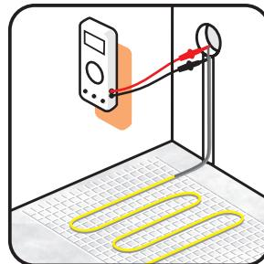
Die Einader-Heizmatte MH besteht aus einem abgeschirmten Einader-Heizkabel, das auf einer selbstklebenden, flexiblen Trägermatte fixiert ist. Die MH Heizmatten sind bestückt mit zwei „Kaltenden“ und zwei zuverlässigen Verbindungsmuffen.
