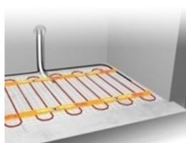
Boden und Wand müssen vor der Verlegung der Heizmatte für Kaltleiter und Temperaturfühler so aufgeschlitzt werden, dass zwei Leerrohre darin bündig versenkt werden können (**Achtung! Kaltleiter und Bodentemperaturfühler nicht im gleichen Rohr verlegen!**). Für den elektronischen Thermostat (Platzierung) sollte an der ausgewählten Stelle eine handelsübliche Unterputzdose mit 230 VAC Netzanschlussleitung aus dem Hausnetz vorhanden sein. Ein Fehlerstromschutzschalter (30 mA) ist vorzusehen.
